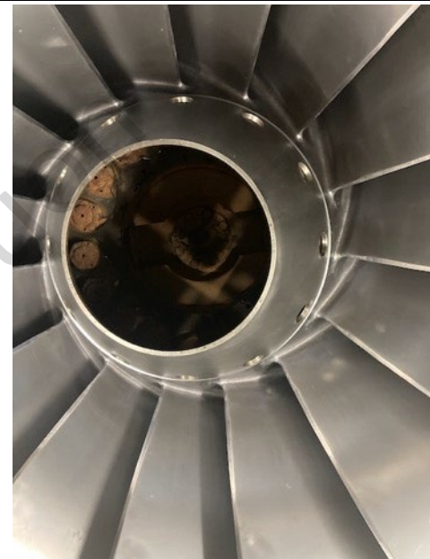
Larawan 33: Turbine runner na nasa mabuting kondisyon habang isinasagawa ang maintenance
